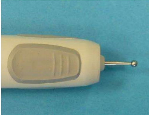
Geen Kleurring zichtbaar - Koppeling in Orde, geen reiniging noodzakelijk.
